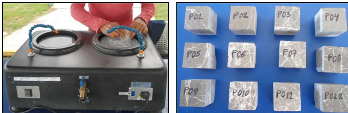
a) Fotografía del lijado de probetas
