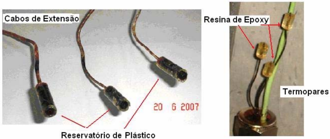
Fig. 4. Cabos de extensão e os termopares após a ruptura.
