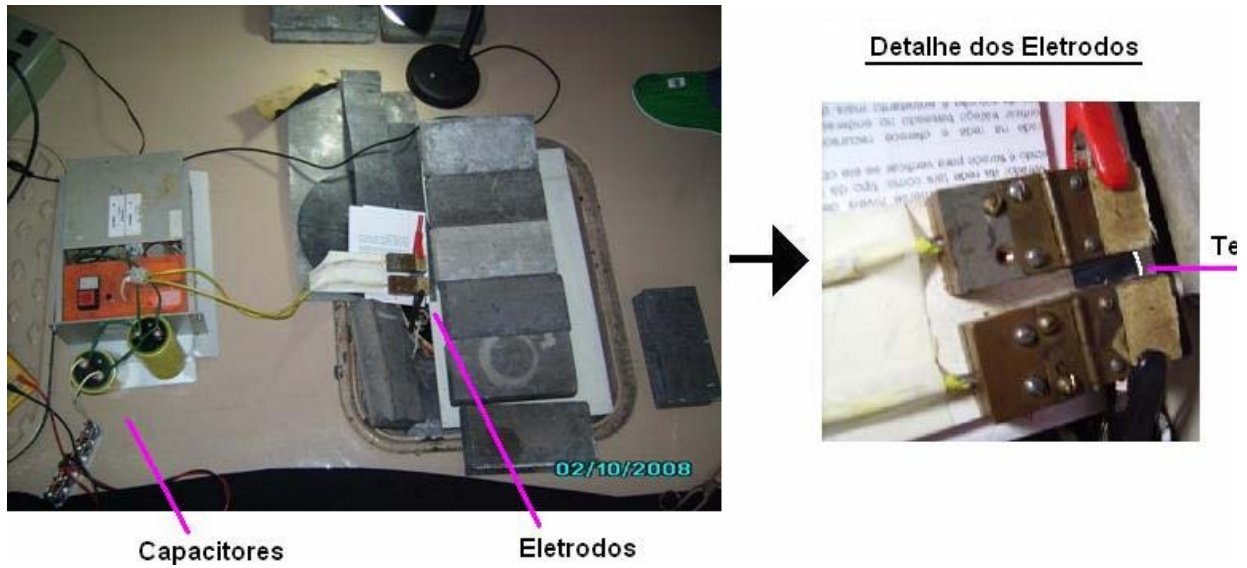
Fig. 7. Montagem utilizada para remoção da blindagem dos termopares por corrente elétrica.
