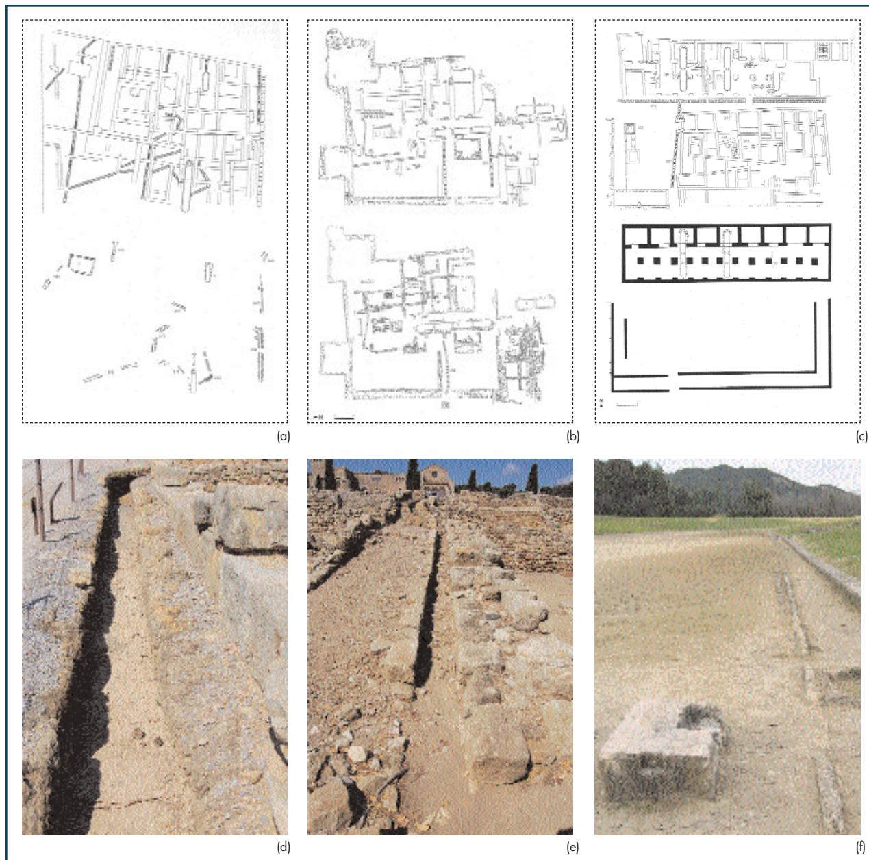
Los antiguos griegos aprendieron rápidamente a abastecer las ciudades mediante sofisticados sistemas de conducciones, canalizaciones y alcantarillado. Los mapas muestran las canalizaciones de la zona sureste (a), suroeste (b), del Ágora y Stoa (c) de Ampurias (Referencia: Burés, L. Les estructures hidràuliques a la ciutat antiga: l'exemple d'Empúries , Monografies Emporitanes 10, Barcelona, 1998) y las imágenes son ejemplo de ello, (d, e) excepto la última (f) que corresponde a una conducción de agua al estadio de Olimpia. Fotografías de Ricard Bru y archivo.
